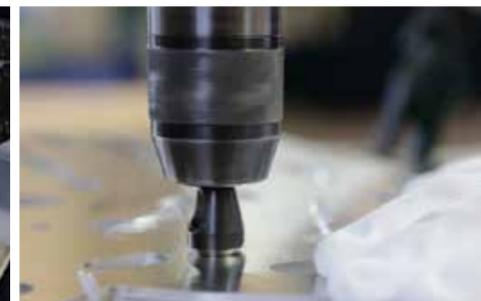
Die Bohrungen für die Befestigung des Motorschutzes werden mit einem Kegelsenker »gesenkt«.
