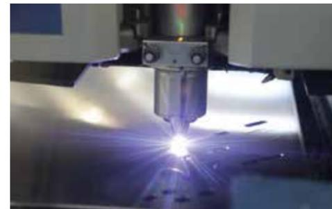
Der Laser schneidet computergesteuert die Aussparungen des Motorschutzes aus
