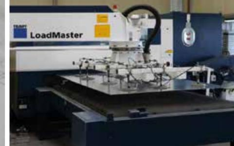
Aufnahme der Blechtafel aus hochfestem Aluminium auf dem Tisch des Laserschneidzentrums
