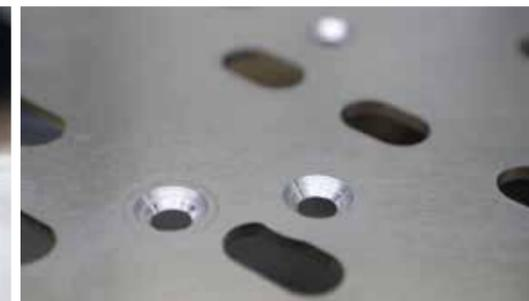
Dies erlaubt später das bündige Verschrauben des Motorschutzes von unten
